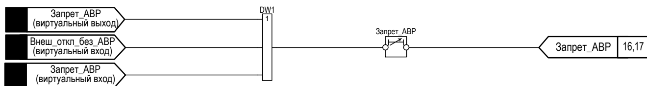
Рисунок 15 – Функциональная схема формирования сигнала «Запрет АВР»
